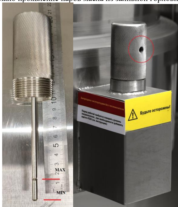
Рис№8 Отметка уровня теплоносителя на щупе. Вентиляционное отверстие масляной рубашке
